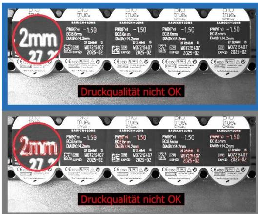
L'œil humain n'est pas gêné par une légère distorsion de l'impression. Cependant, un logiciel d'inspection d'impression sans compensation de distorsion (cadre gris) produira toujours de faux rejets sans trouver les vrais défauts. Le logiciel d'inspection d'impression Compar compense la distorsion (cadre bleu). (Photo : Compar)
