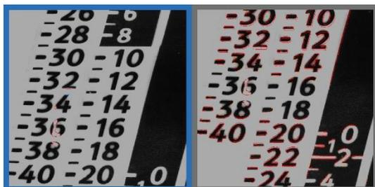
outre, les caractéristiques du procédé d'impression utilisé doivent toujours être prises en compte. L'impression au laser, par exemple, peut provoquer des brûlures indésirables à la surface des pièces. L'impression numérique avec des têtes d'impression à jet d'encre peut provoquer l'écoulement de gouttelettes adjacentes les unes dans les autres, et on peut souvent s'attendre à des distorsions ou à des "effets d'accordéon" lors de l'impression de surfaces courbes.
