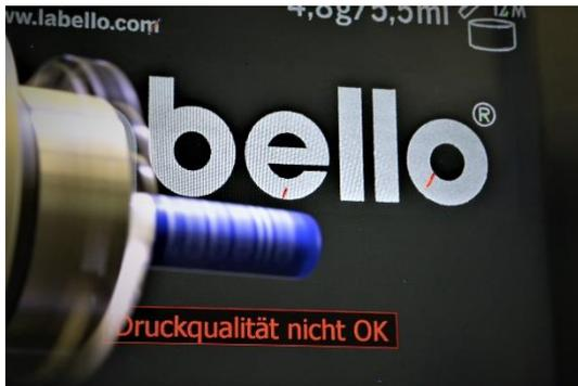
Analyse de l'impression circulaire sur un baume à lèvres en rotation à l'aide de la caméra située au-dessus. Les défauts des lettres "e" et "o" sont signalés en couleur (Photo : Compar)
