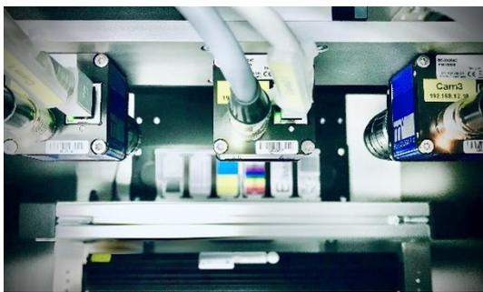
Exemple d'une unité fabriquée par Compar pour un contrôle de qualité séparé en laboratoire. A l'intérieur, il y a trois systèmes de caméras disposés en parallèle (Photo : Compar)
