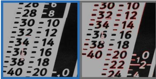
Bien qu'il faille détecter les véritables erreurs de dessin (cadre bleu à gauche), le logiciel peut tolérer les "distorsions en accordéon" de l'impression ronde (cadre gris à droite) contrôlée par des paramètres (graphique : Compar)
